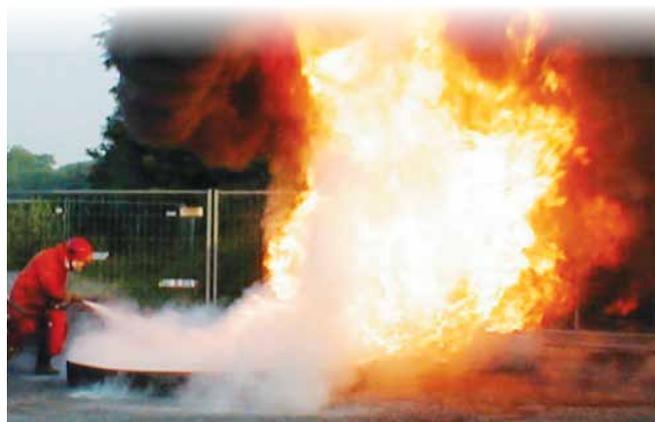
La classificazione della capacità estinguente degli estintori per fuochi di classe B è indicata nel seguente prospetto, i numeri nella prima colonna del prospetto si riferiscono alle dimensioni del focolare di prova.
